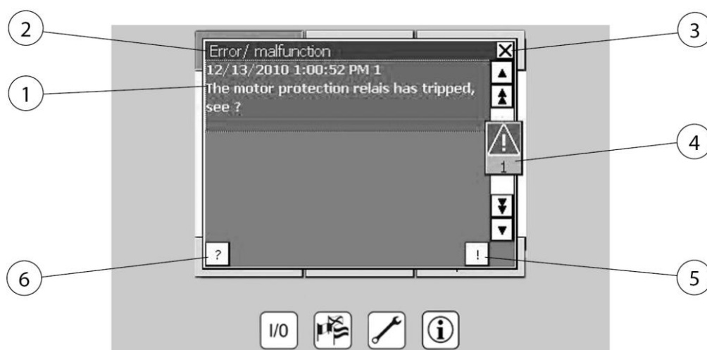
Рис. 33: Сообщение о неисправности органов управления
